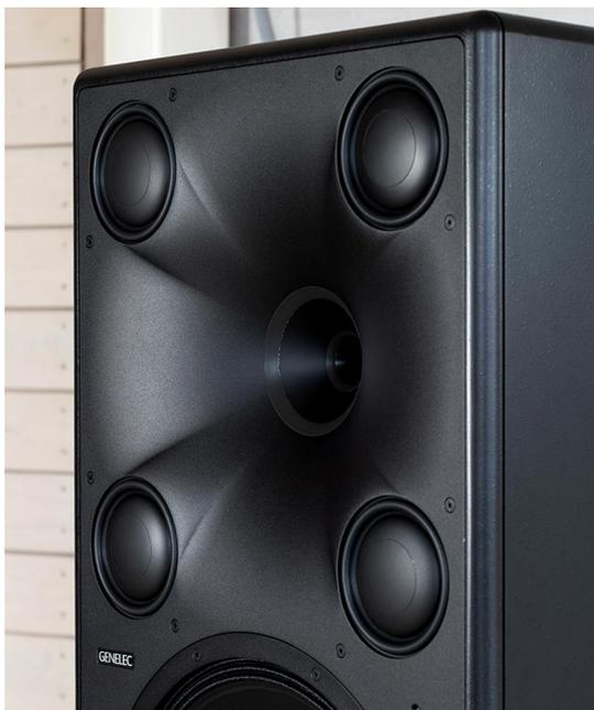
ポイント・ソース理論を徹底的に突き詰めた 8381A では、新たに Genelec が開発/設計した新開発の同軸ミッドレンジ/ツイーターの MDC™ (Minimum Diffraction Coaxial) を採用。中心に Φ25mm、スロート長 13mm のコンプレッションツイーターを配置した、127mm (5 インチ) のドライバーです。その周りを囲むように配置された4つのドーム型ドライバーからなる QMS (Quad Midrange System) は、大きな面積のウェーブガイド DCW™ (Directivity Control Waveguide) により広帯域にわたって指向性を制御。音響軸内/外を問わずフレットなレスポンスを実現し、部屋の残量がサウンドに与える影響を極限まで抑えています。
