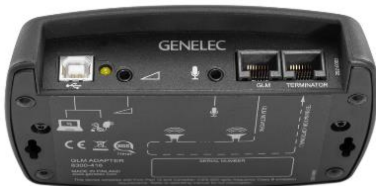
図 47. GLM ネットワーク・アダプターの接続端子（左から、コンピューターまたは電源アダプターへ接続する USB 端子、ハードウェア・レベル・コントローラー入力端子、GLM 測定用マイクロフォン入力端子、GLM ネットワーク端子、ターミネーター端子）
