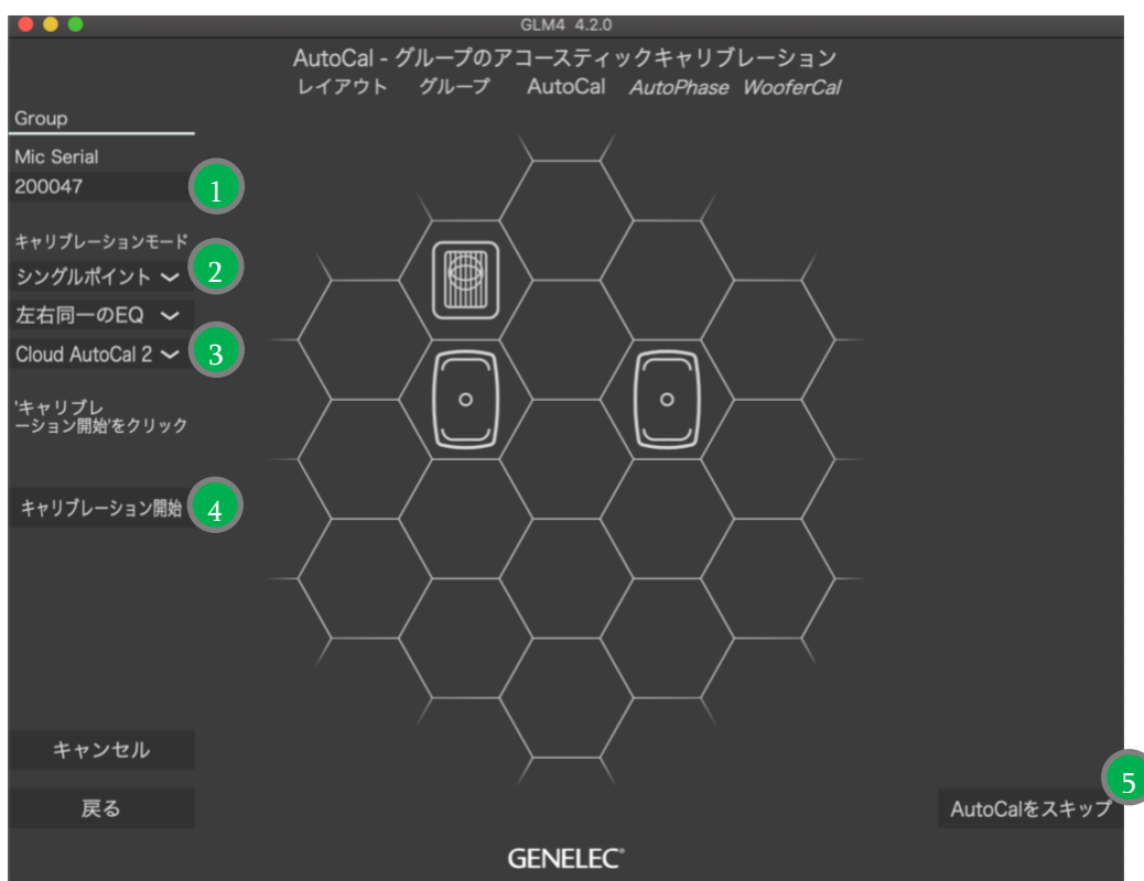
図 18. AutoCal 自動システム・キャリブレーションの実行手順
