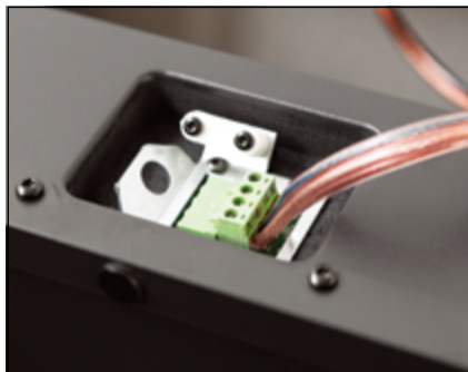
図 4. スピーカー・ケーブルの接続
