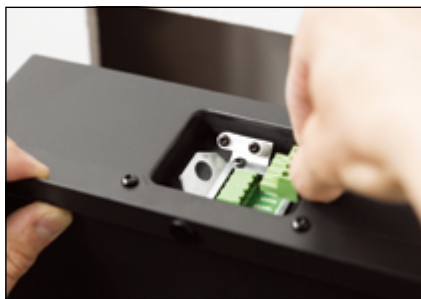
図 3. スピーカー・ケーブルの接続
